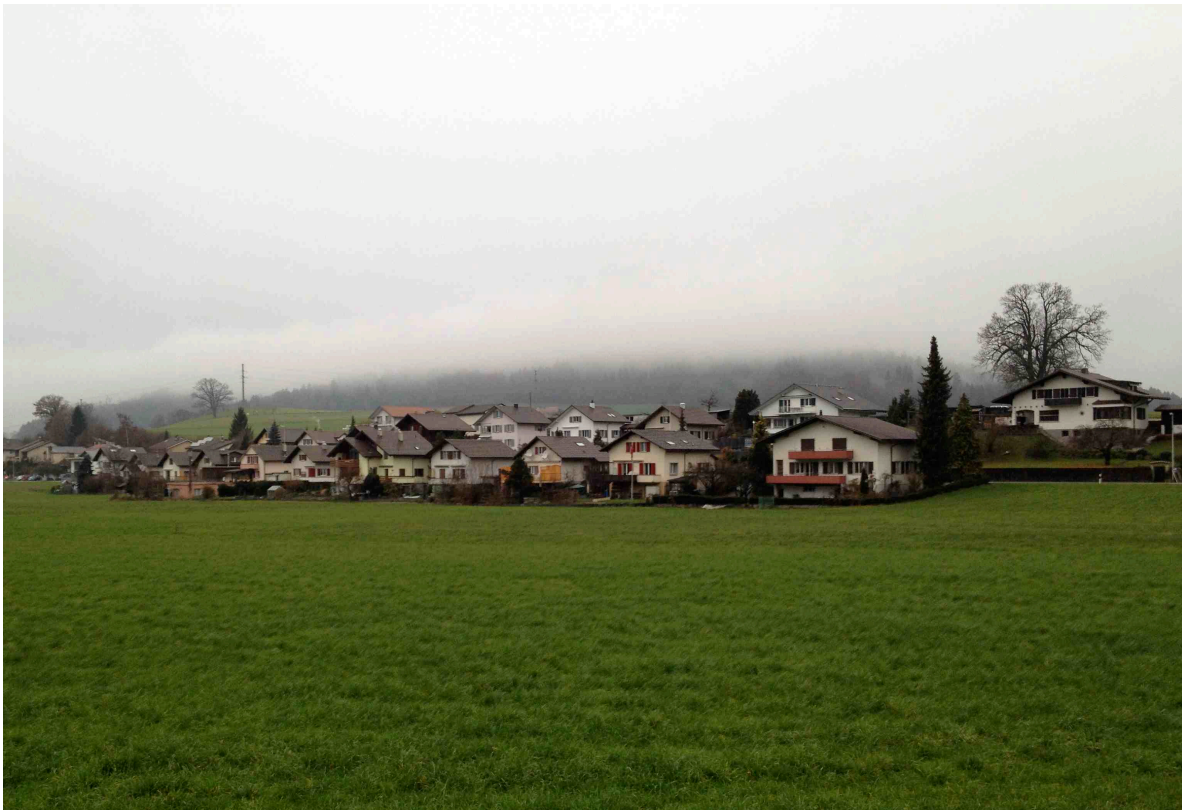
Einfamilienhausquartier Viermal so grosse Abkühlungsfläche im Verhältnis zur Wohnfläche
